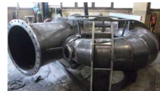
Strutture monolitiche saldate per turbine idrauliche kaplan - francis - pelton Importi vari
