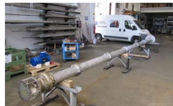
Pompe intermedie in fase di assemblaggio presso l'officina
