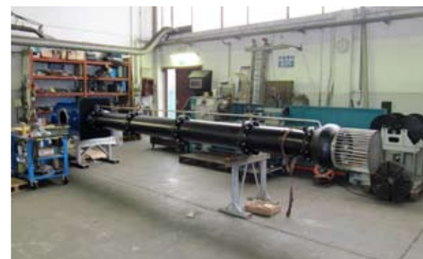
ILVA - Taranto Reverse engineering elettropompa per acciaieria Importi vari
