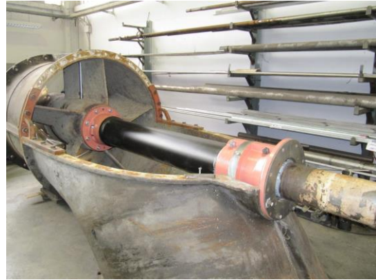
Riparazione gruppo n. 1 di pompaggio Pellizzari tipo FIER 10.000 nell'impianto Crevenzosa.
