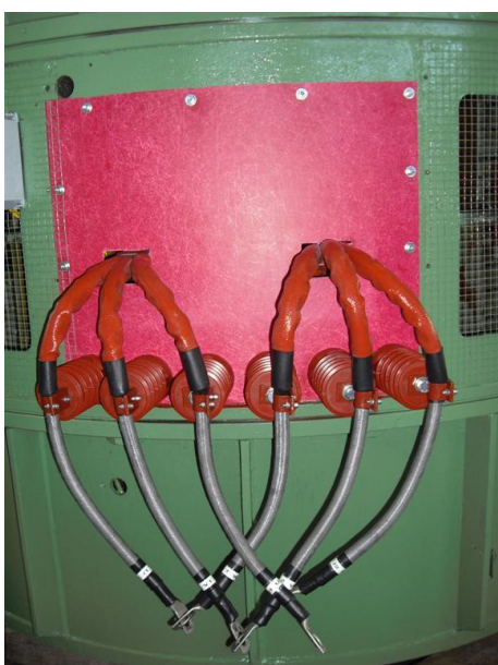
Pellizzari GV 5000/8 - 2500 CV - 735 giri/min - 6600 Volt - 50 Hz Impianto Yliki - Mourikion EYDAP Grecia
