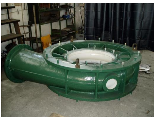
Pompa AV 500/800 classe 1958 Q = 1100 l/sec H = 85 mt P = 1700 HP n = 980 g/min
