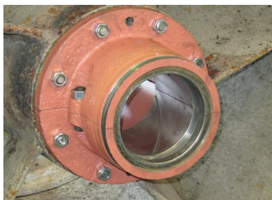
Imp. Cartoccio - gruppo rotore - bronzine in metallo bianco - bussole di protezione albero
