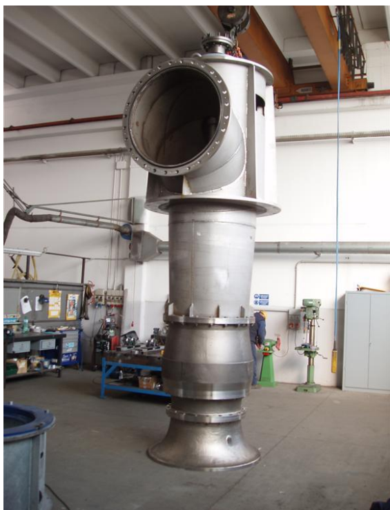
Pompa elicocentrifuga intercambiabile con l'esistente inserita nel petrolchimico.
