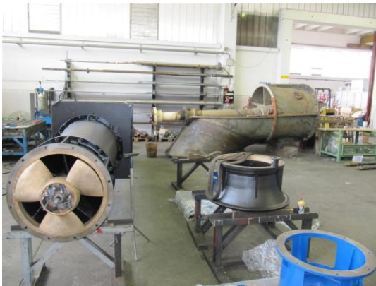
Riparazione gruppo n. 1 di pompaggio Pellizzari tipo FIER 10.000 nell'impianto Crevenzosa.
