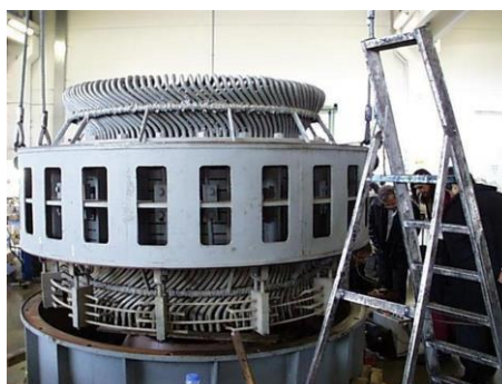
Pellizzari GV 5000/8 - 2500 CV - 735 giri/min - 6600 Volt - 50 Hz Impianto Yliki - Mourikion EYDAP Grecia
