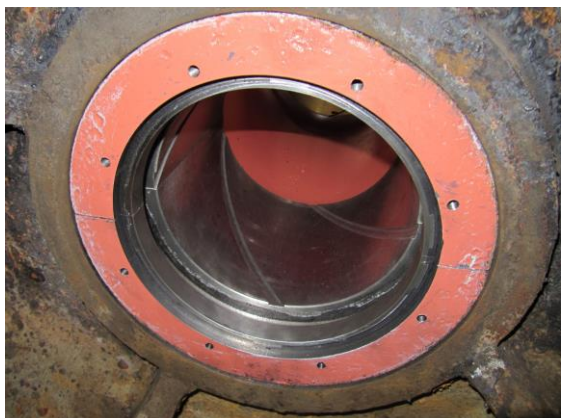
Imp. Cartoccio - gruppo rotore - bronzine in metallo bianco - bussole di protezione albero
