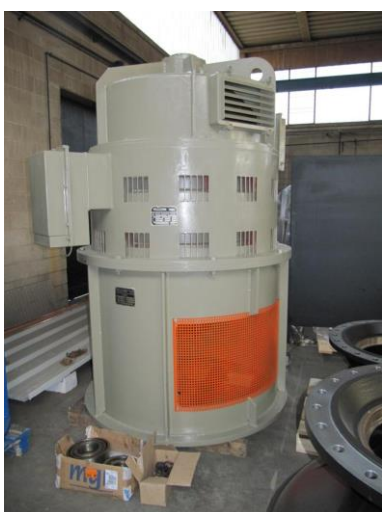
Pellizzari GAVS 1250/28 - 135 CV - 210 giri/min - 28 poli Idrovora Cavanella Po, Consorzio Bonifica Adige Po
