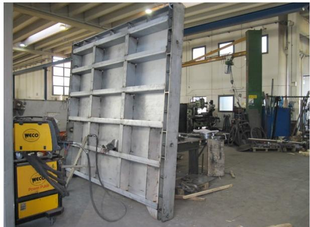
N. 2 Paratoie piane a scorrimento motorizzate dim. 3,0 x 2,1 m, tenuta 4 lati, carico idraulico 6,2 m, in acciaio inox AISI 304
