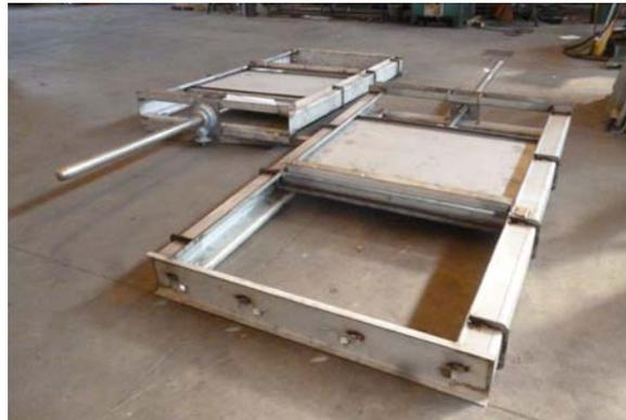
N. 1 Paratoia piana motorizzata d'uscita dim. 1,3 x 1,1 m, tenuta 4 lati, carico idraulico 5,45 m, in acciaio inox AISI 304
