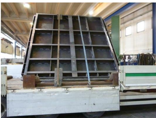
N. 6 Paratoie opera di presa 4,0 x 3,5 m, tenuta 4 lati, in acciaio al carbonio S355JR, comando oleodinamico
