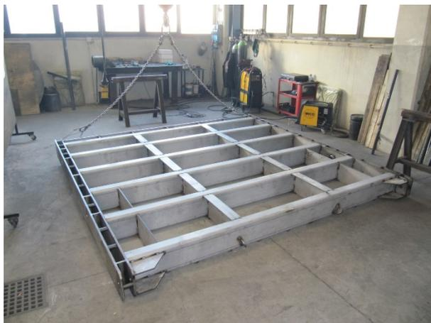
N. 2 Paratoie piane a scorrimento motorizzate dim. 3,0 x 2,1 m, tenuta 4 lati, carico idraulico 5,8 m, in acciaio inox AISI 304
