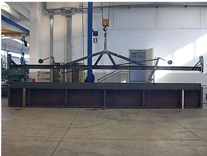
N. 4 Paratoie piane a scorrimento motorizzate dim. 7,5 x 2,6 m, tenuta 4 lati, carico idraulico 4,5 m, in acciaio inox AISI 304
