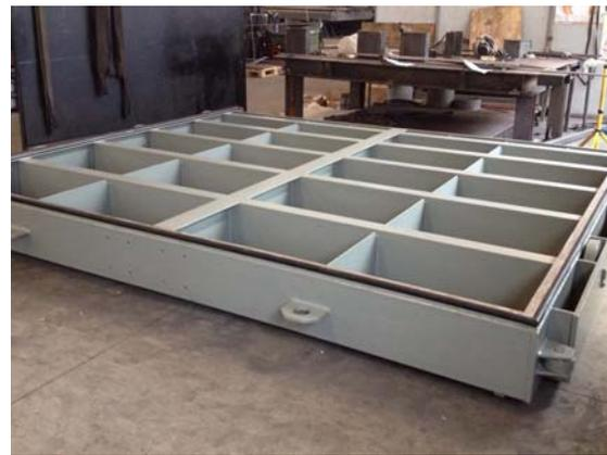
N. 1 Paratoia presidio turbina 5,8 x 5,3 m, tenuta 4 lati, in acciaio al carbonio S355JR, comando oleodinamico
