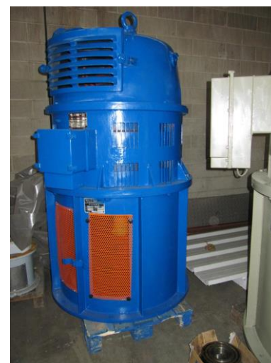
Pellizzari GAVF 1000/16 - 195 CV - 365 rpm - 16 poles Zuccarello plant, Consorzio di Bonifica Acque Risorgive
