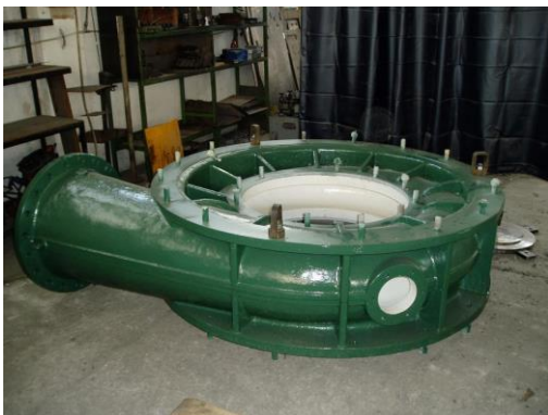
Pump type: AV 500/800, year 1958 Q = 1100 l/sec H = 85 m P = 1700 HP n = 980 g/min
