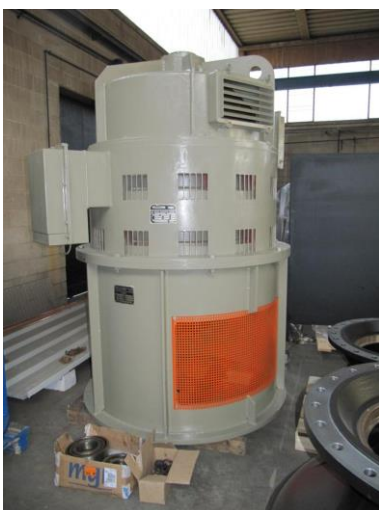
Pellizzari GAVS 1250/28 - 135 CV - 210 rpm - 28 poles Cavanella Po plant, Consorzio Bonifica Adige Po
