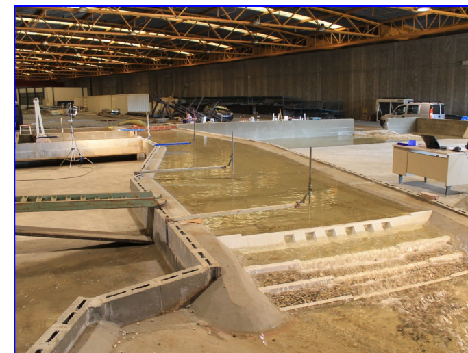
Modello fisico in scala 1:40 per la verifica delle caratteristiche idrauliche delle opere di laminazione delle piene del fiume Agno-Guà
