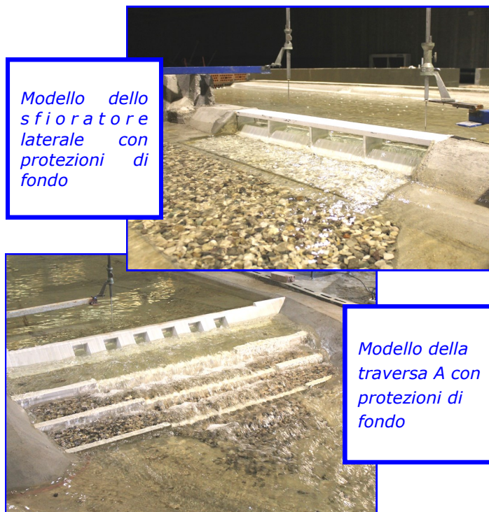
Modello fisico in scala 1:40 per la verifica delle caratteristiche idrauliche delle opere di laminazione delle piene del fiume Agno-Guà
